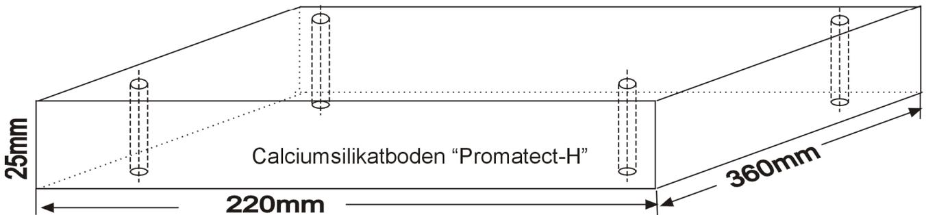
Die Gehäuse müssen in der Nähe der BSK befestigt werden. Die Einbaubedingungen müssen den Vorgaben des Materialherstellers entsprechen. Feuchte und aggressive Atmosphären sind zu vermeiden. Die erforderlichen Spezialdübel sind im Lieferumfang enthalten. Nicht enthalten sind die Setzwerkzeuge für diese Dübel. (Sind als Sonderzubehör lieferbar)
